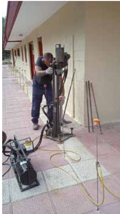
Realización de ensayo DPM-30
