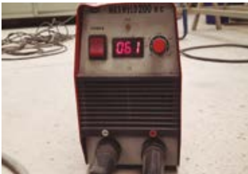
Fig 89. Electro-maquina utilizada para soldar
