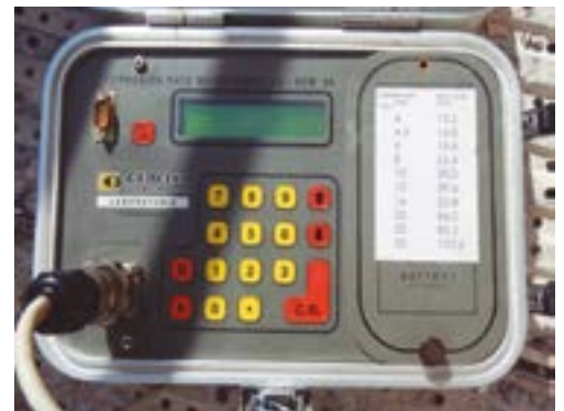
Fig 73. Panel de control medidor de corrosión Gecor
