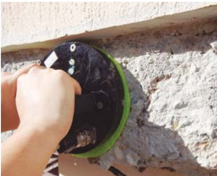
Fig 74. Aplicación del sensor en el hormi-gón
