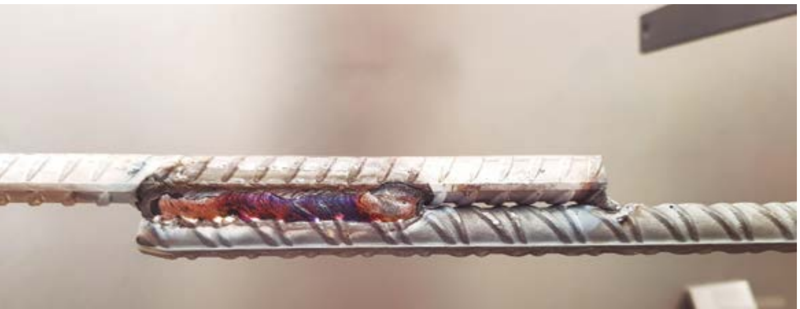
Fig 96. Detalle de primer tramo de soldadura incandescente
