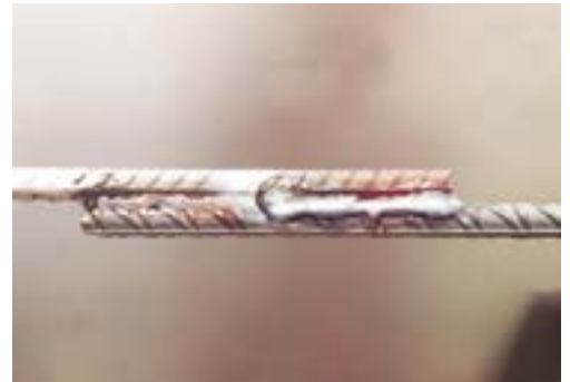
Fig 97. Continuidad en el cordón de soldadura
