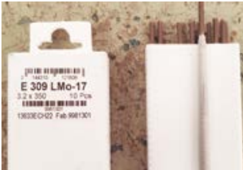
Fig 88. Electrodo revestido recomendado
