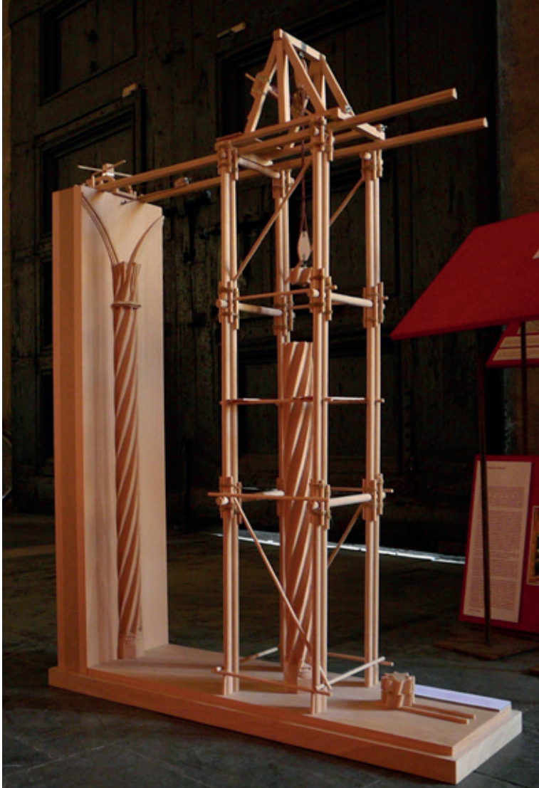
Maqueta de grúa puente para la construcción de las columnas del salón de comerciantes de la lonja de Valencia.
